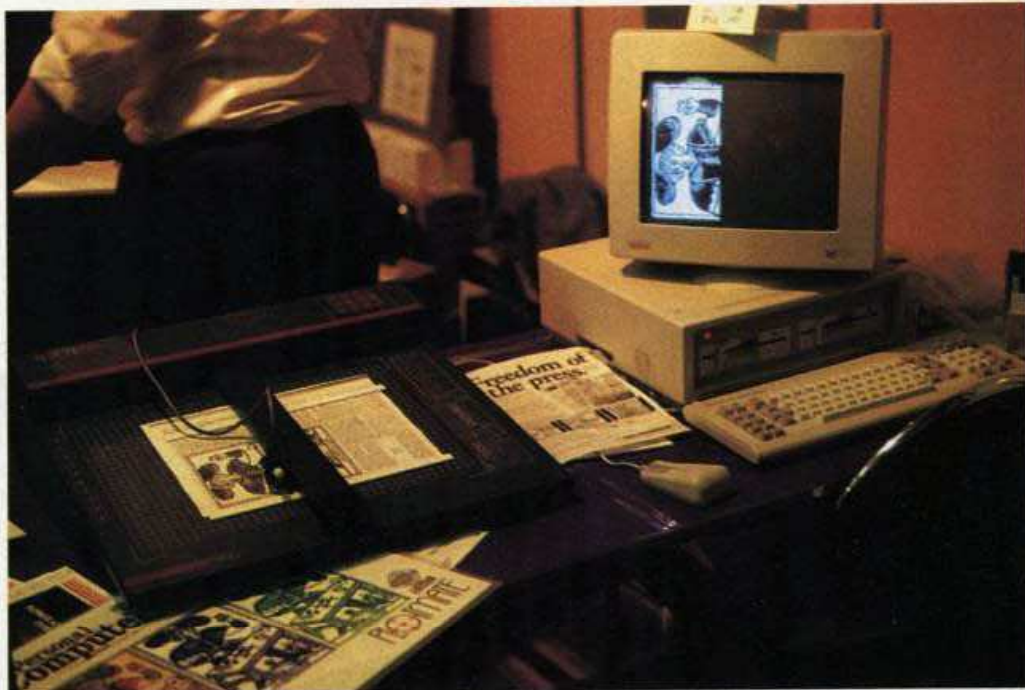
Plotter zweckentfremdet: Mit einem Scanner als Zubehör tastet der »Plotmate« beliebige Vorlagen ab und gibt die Information an den Schneider PC
